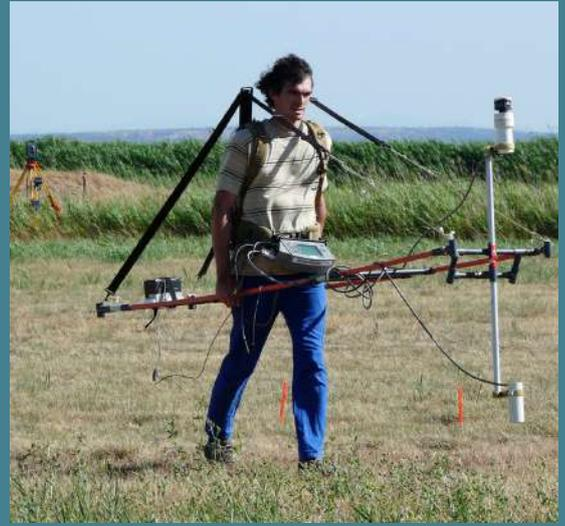
Prospección geofísica con magnetómetro en Mandirac © C. Sánchez, Cnrs
